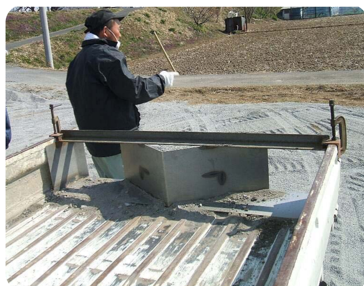
構成員が考案・作成した砂利補充用アタッチメント
